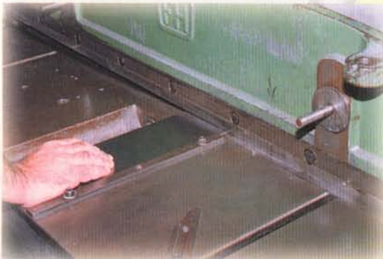
Figura 8.14. Corte de lámina con cizalla
